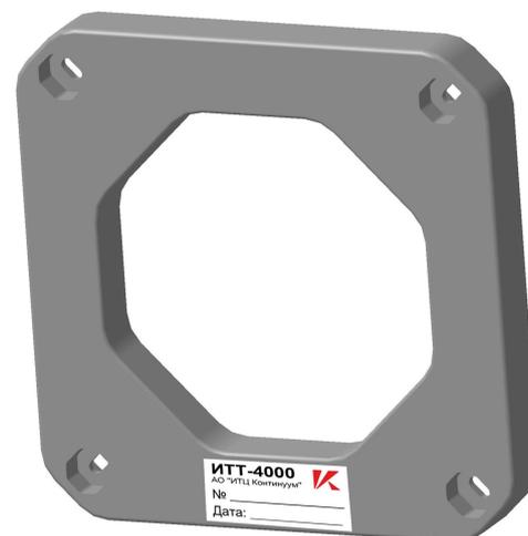
Датчик тока ИТТ-4000 (ИТТ-6000, ИТТ-10000) предназначен для измерения постоянных, переменных, импульсных токов или их комбинаций. Датчик построен по принципу дискретного интегрирования по закону полного тока и обеспечивают гальваническую развязку между первичными и вторичными цепями.
